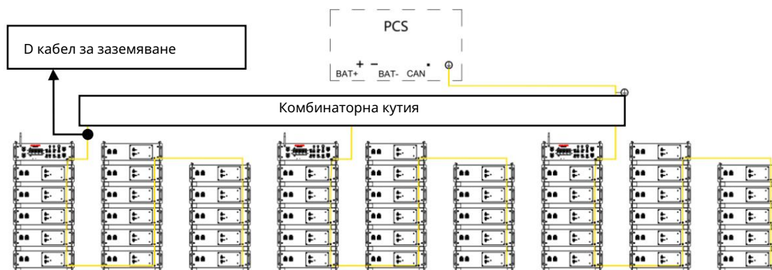
Фигура 3.21с Паралелни заземяващи връзки за CISS 65~80-RS (3-кълъстерни паралелни шкафове на CISS 80-RS като пример)
