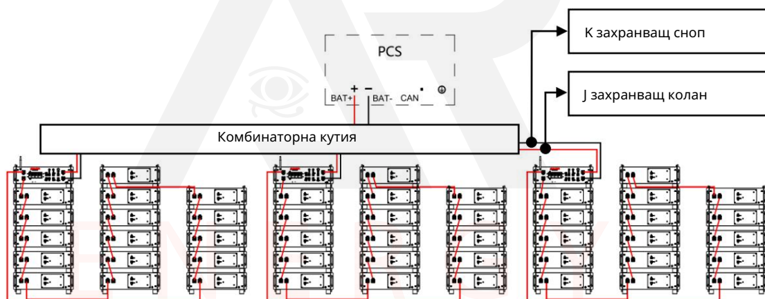
Фигура 3.22c Паралелни захранващи връзки за CISS 65~80-RS (3-кълъстерни паралелни шкафове на CISS 80-RS като пример)
